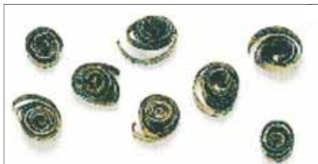
Толстая, тяжелая, с голубым отливом стружка – плотно перегружено
