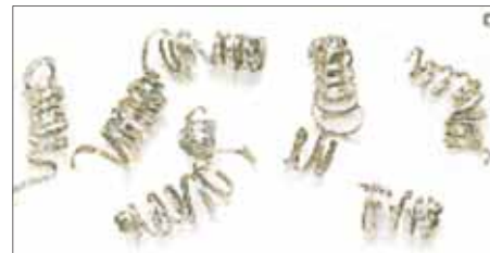
Свободно намотанная (витая) стружка – идеальные условия резания
