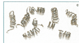
Свободно намотанная (витая) стружка - идеальные условия резания
