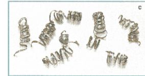
Свободно намотанная (витая) стружка - идеальные условия резания
